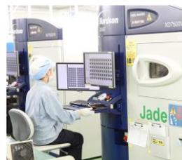
X線による非破壊検査
