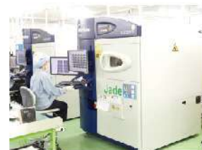
X線による非破壊検査
